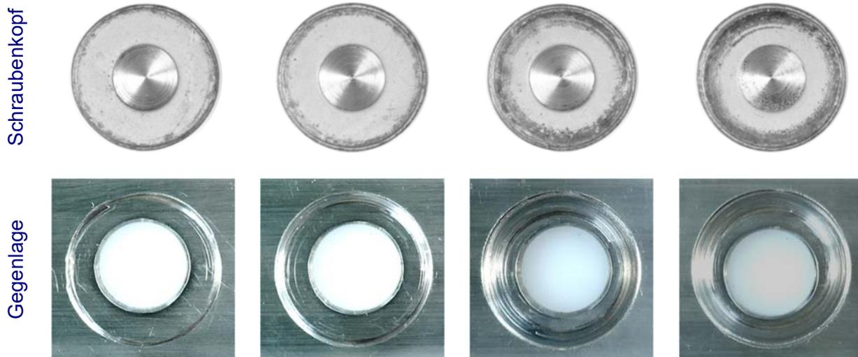
Bild 9: Veränderung der Kontaktfläche auf dem Schraubenkopf (Stahl, oben) und der Gegenlage (Aluminium, unten) in Abhängigkeit der Vorspannkraft  $F$  (von links nach rechts ansteigend) bei Außenträgern mit geringem Schirmungswinkel
