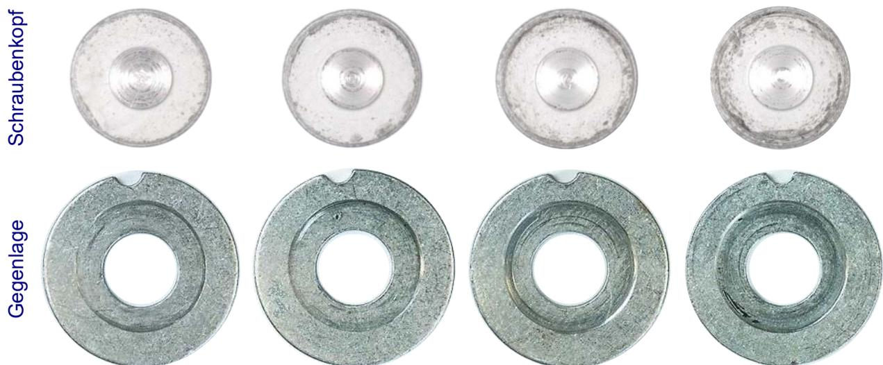
Bild 8: Veränderung der Kontaktfläche auf dem Schraubenkopf (Stahl, oben) und der Gegenlage (Stahl, unten) in Abhängigkeit der Vorspannkraft  $F$  (von links nach rechts ansteigend) bei Außenträgern mit geringem Schirmungswinkel
