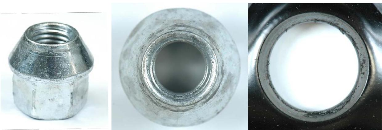
Bild 15: Radmutter (links und Mitte) und Schüssel des Stahlrades mit KTL beschichtet (rechts)
