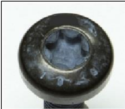
Abb.2. Beispiel ZnNi, schwarz passiviert, mit schwarzer Deckschicht – Grauschleier nach Korrosionsbelastung.
