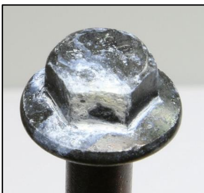
Abb.3. Beispiel ZnFe, schwarz passiviert, mit schwarzer Deckschicht – Weißkorrosion nach Korrosionsbelastung.
