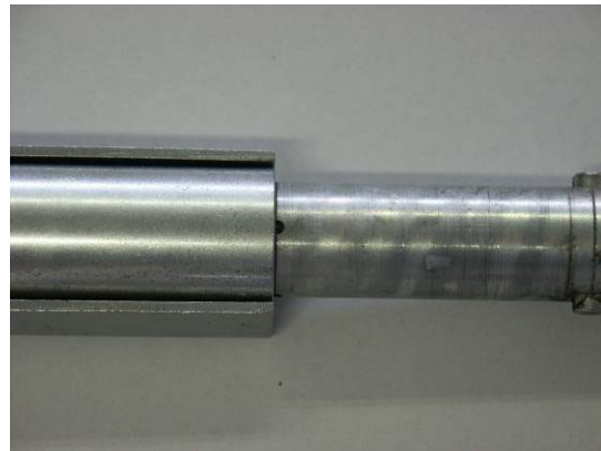
Bild 7: Mitte der Kontrollbohrung in Deckung mit der Kante der Führungshülse
