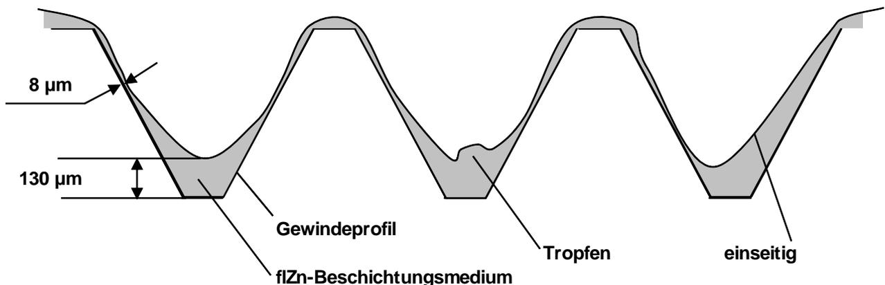
**Bild 2:** Problematik der Verteilung des flZn-Beschichtungsmediums in Innengewinden (beispielhafte Darstellung des Einflusses der Oberflächenspannung und der Schöpfwirkung)
