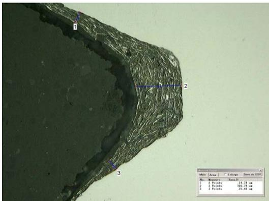
**Bild 1:** Beschichtungsanhäufung von flZn-Überzügen im Gewindegrund (Praxisbeispiel)
