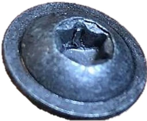
**Bild 5:** Massive Rückstände Base-Coat (n.i.O. – nicht verbaubar)
