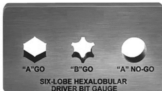
**Bild 7:** Prüflehre am Beispiel für Innensechsrund Bits
