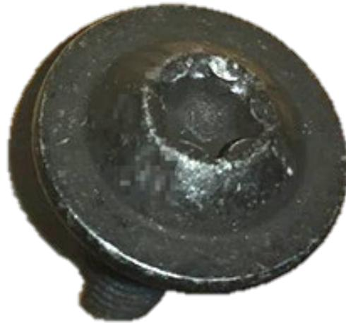
**Bild 6:** Massive Rückstände Base-Coat (n.i.O. – nicht verbaubar)
