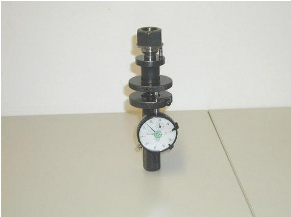
**Kurzbeschreibung:** Die zu prüfende Mutter wird auf einen konischen Gewindedorn spielfrei aufgenommen und der Messtaster wird gegen die Stirnseite der Mutter gedrückt. Die Prüfung im Umfang erfolgt durch Drehung des mittleren Rändels.
