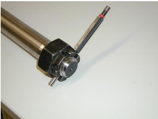
Der Grenzlehndorn wird durch die Nut und Innenbohrung eines Gewindezapfens geführt.
