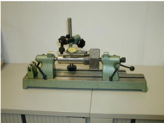
**Kurzbeschreibung:** Die hier abgebildete Prüflehre mit konischem Gewinde wurde in einer Spannung zerspanend hergestellt. Die Mutter wird so spielfrei aufgenommen und während einer Drehung der Prüflehre mit dem Messuhr abgetastet.
