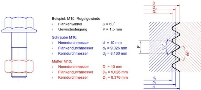
Reibungszahlen sind einheitenlose Hilfsgrößen, die aus den zur Verfügung stehenden Messgrößen und der Geometrie des jeweiligen Verbindungselements berechnet werden. Daher wird in diesem Seminar neben den Grundlagen zur Ermittlung von Reibungszahlen auch das für diese Zusammenhänge erforderliche Basiswissen für Schrauben und Muttern vermittelt.
